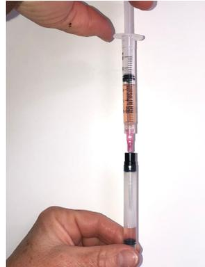
► Nun setzen Sie die Luftkammer unter Druck. Ziehen Sie hierzu in der Druckaufbauspritze ca. 20 ml – 30 ml Luft auf.
